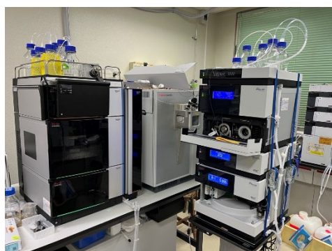
高分解能 LC-MS/MS(Orbitrap)
